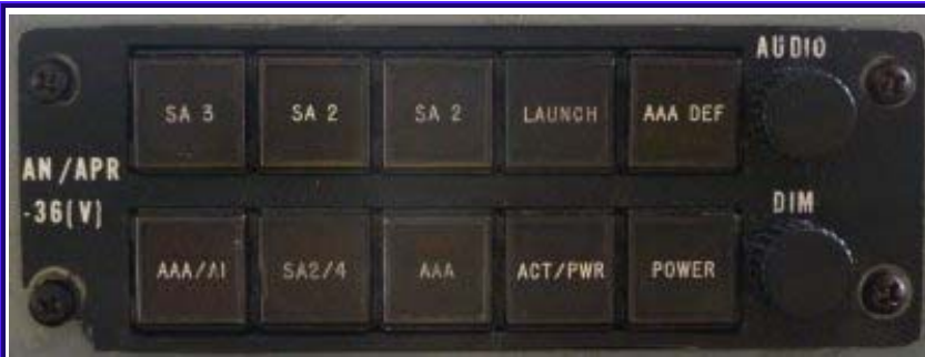
AN / APR-36 unidad de indicador de control de amenazas de visualización (V) producido por tecnología aplicada, División de Itek Corporation, EE.UU. Utilizado en F-4D, F-4E y aviones F-4F Phantom.
