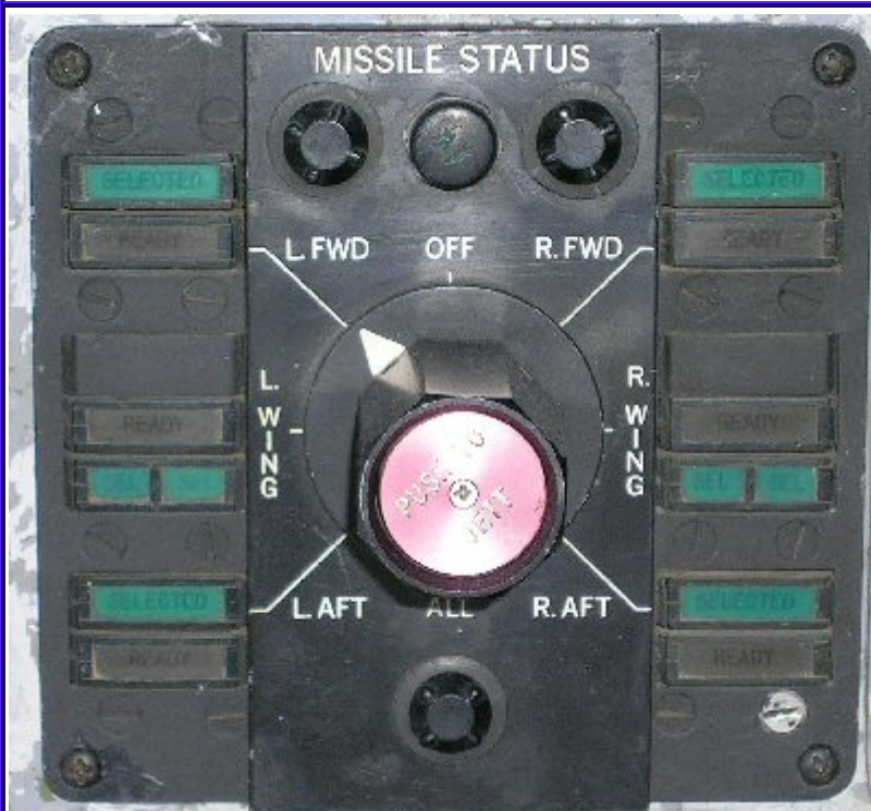
Las luces de esta unidad de lectura "seleccionados" (verde), "listo" (ámbar), "seleccionado" (verde), "listo" (ámbar), "sw / sw" (verde), "seleccionado" (verde) y "listo" (ámbar). Iluminación en el panel de luz del borde.
