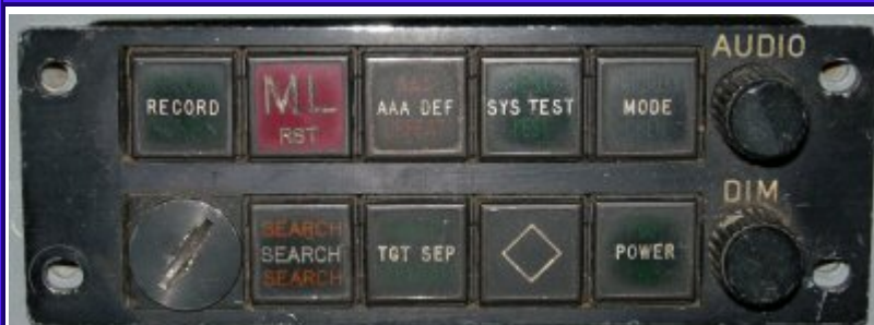
Panel de la pantalla de alerta de amenaza producida por A.E.L. Israel Ltd Electronics Industries en 1983. Se utiliza en los aviones de la Fuerza Aérea israelí F-4E Phantom
