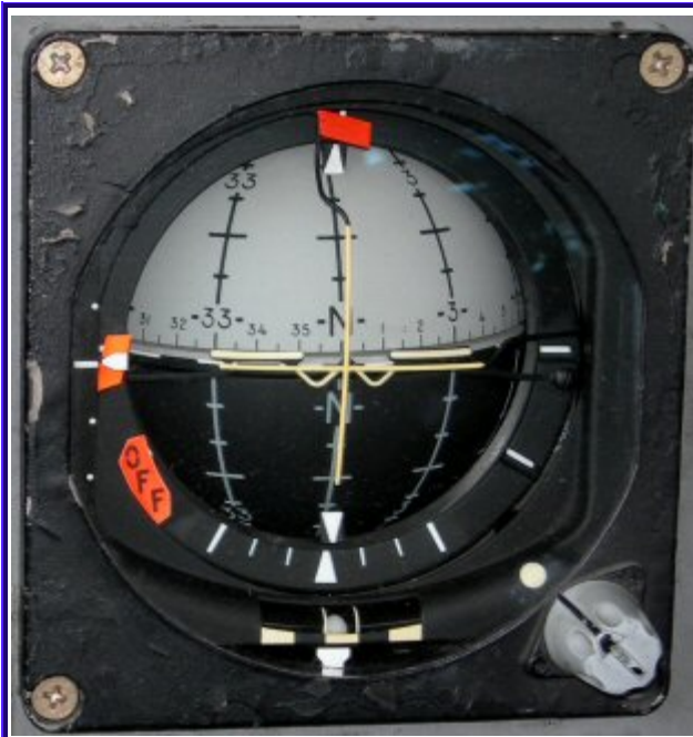
ARU-11/A Director Artificial de Indicación u Horizonte Artificial.
