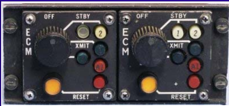
F-4C ECM cabina trasera (ECM) del panel de control.
