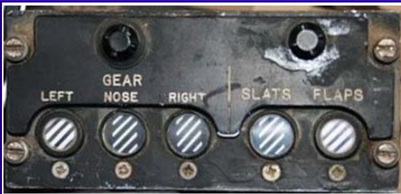
Panel de indicación del Tren de Aterrizaje de indicación de los Slats y de los Flaps.
